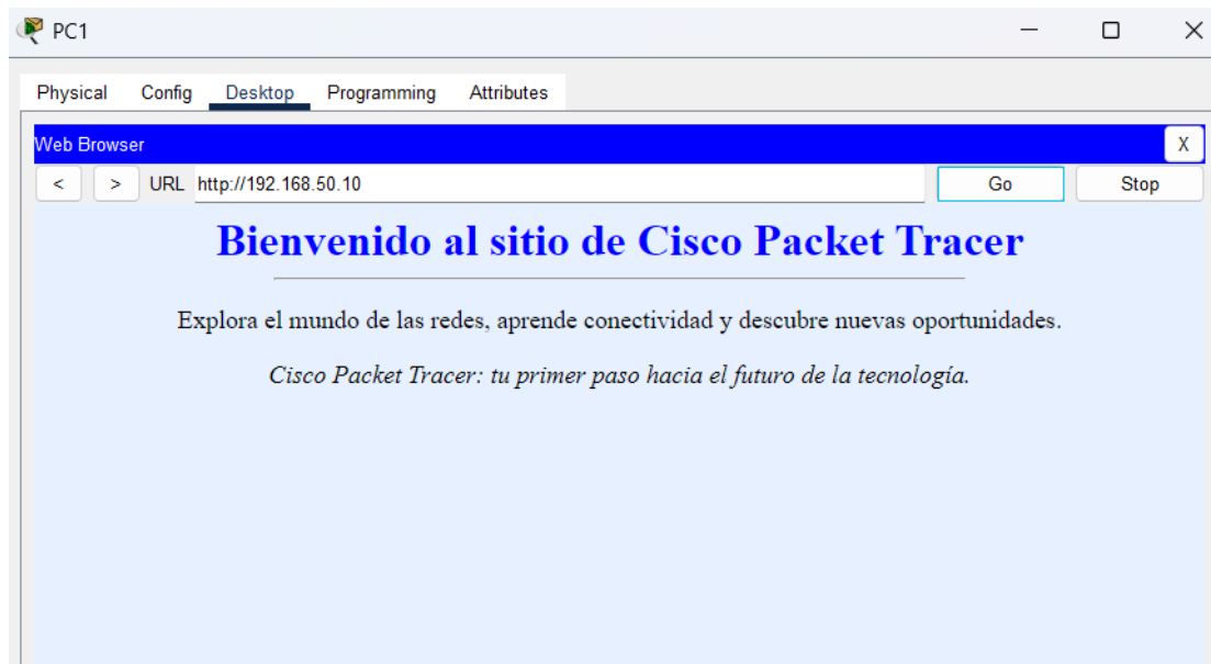
Figura 5. Acceso HTTP autorizado desde VLAN 10 hacia el servidor web en VLAN 50.
